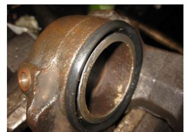
A l'origine ce cache poussière a une lèvre d'un diamètre légèrement supérieur à l'alésage qui le retient, ce qui permet sa mise en place facile avant de placer le piston. Le cache poussière reçu a un diamètre inférieur et il est impossible de le monter comme la fois précédente.
