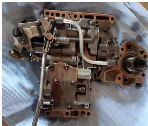
Bloc de commande démonté
