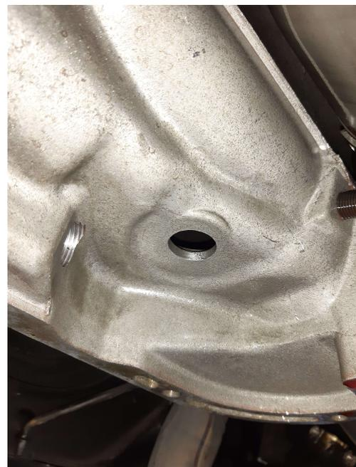
Percement pour le levier de commande
