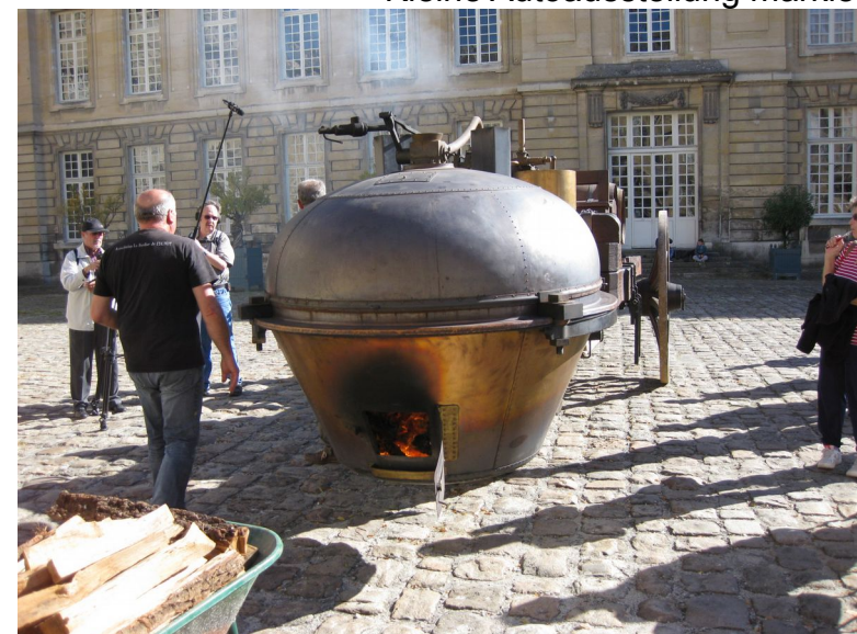
Die Kopie des Fardier von Nicolas Joseph Cugnot hergestellt im Jahre 1769, 1. Frontantrieb der Geschichte, Verbrauch 1 Kub Holz für 2km !!
