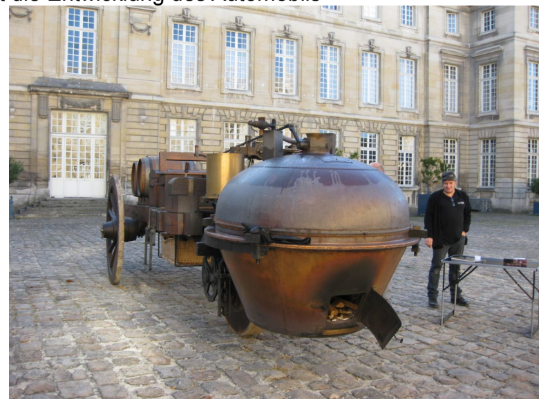
Die Kopie des Fardier von Nicolas Joseph Cugnot hergestellt im Jahre 1769, 1. Frontantrieb der Geschichte, Verbrauch 1 Kub Holz für 2km !!
