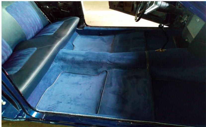
auf dem Programm: Karosseriearbeiten, komplette Lackierung in der ursprünglichen metallic-blauen Farbe, Unterbodenbehandlung, Kreation einer Edelstahllinie mit zwei Auspuffendrohren im V8-Stil, polieren und neu verchromte Stoßfänger, Polsterarbeiten : Dachhimmel, Teppiche und zentraleteil von Sitzen und Bank.
