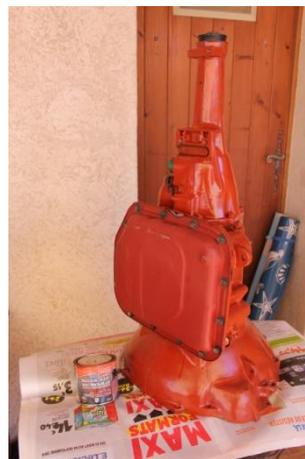
La peinture orange de protection appliquée aussi bien sur le bloc moteur que sur les éléments de transmission est de type « marine » et résiste à une température de 165°C.
