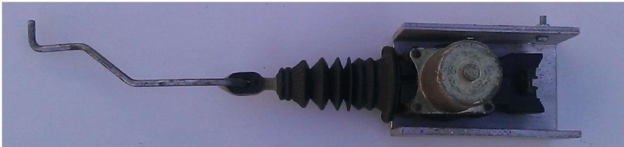
Zentralisierungsmotor mit nachgeschnittener Steuerstange
